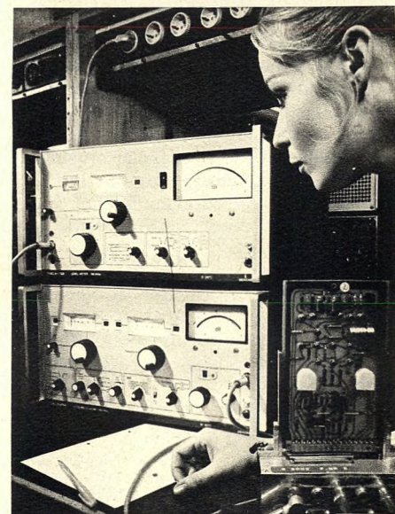
Dieser Pegelmeßplatz besteht aus dem Pegelsender W 2072 und dem Pegelmessgerät D 2072
