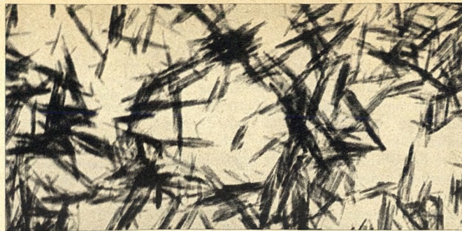
Die aktive Schicht des Magnetbandes unter dem Elektronenmikroskop bei 20 000facher Vergrößerung. Links: herkömmliches Tonband mit etwa 150 Millionen magnetisierbarer Eisenoxidteilchen pro Quadratmillimeter; rechts: LH-Band mit noch höherer magnetischer Dichte
